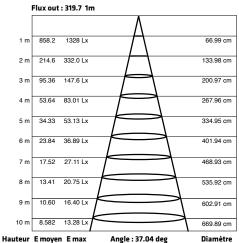
Note: Les courbes indiquent la zone éclairée et la moyenne d'éclairage lorsque le luminaire est à différentes distances.
