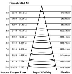
Note : Les courbes indiquent la zone éclairée et la movenne d'éclairage lorsque le luminaire est à différentes distances
