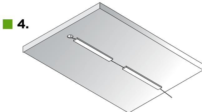
4. Connectez la première barre linéaire au connecteur de la boîte de jonction. Ensuite, connectez les autres barres linéaires à la précédente, une par une. La puissance maximale est indiquée ci-dessous.
