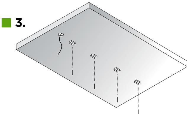
3. Installez les attaches en acier inoxydable avec les petites vis sous le fond de l'armoire. Il faut 2 clips pour tenir chaque barre linéaire et s'assurer qu'ils sont bien alignés en ligne droite.
