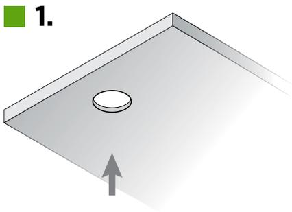
1. Déterminer l'emplacement de l'installation et découper un trou de 1" de diamètre dans le dessous de l'armoire.
